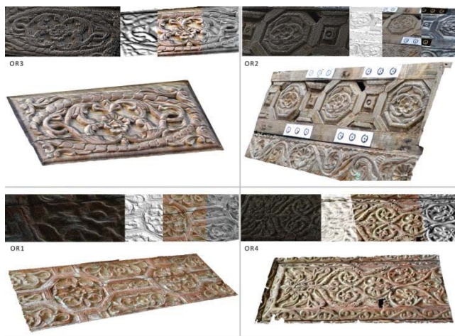
Figura 2. Ejemplos de los diferentes resultados de elementos ornamentales complejos obtenidos en el proceso con el módulo Scanner.
