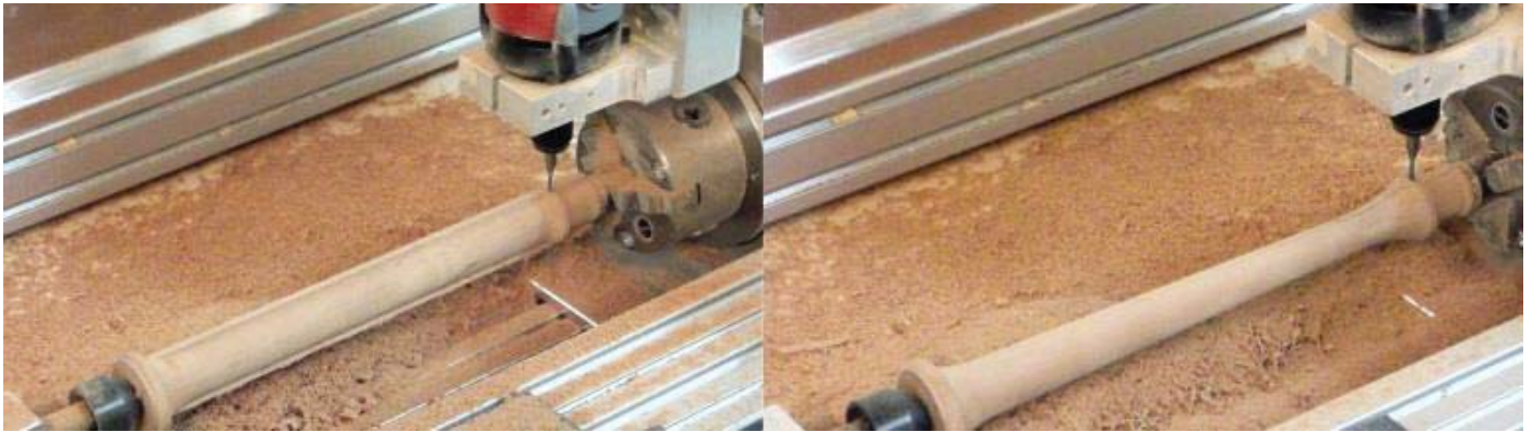
Figura 3. Proceso de fresado en madera de alta densidad, mediante CNC de 4 ejes, del exterior de un clarín de cornamusa catalana del siglo XVIII, con conversión de sucesión de puntos a curva continua, mediante interpolación NURBS. ©Galdric Santana 2009.
