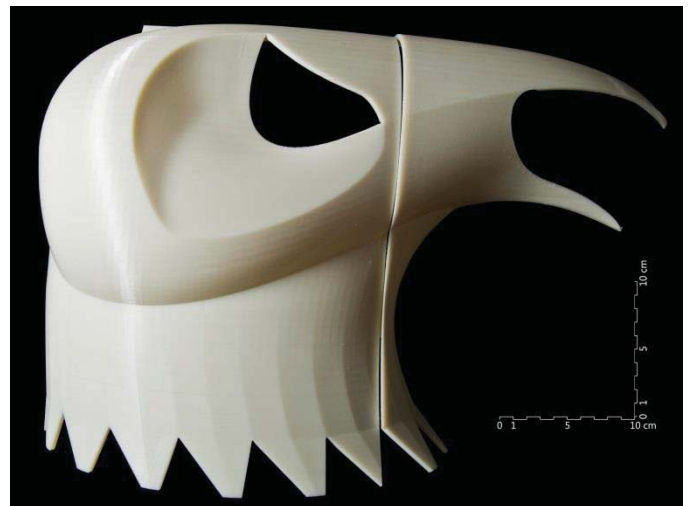
Figura 4. Impresión 3D en ABS por termo-extrusión, de un motivo escultórico en 2 piezas. Ejemplo de resolución de malla inferior a la del cabezal de la impresora. Molde para fundición en bronce, de la cabeza escultórica del “Gall del penell” del monasterio de Sant Cugat del Vallès (S.XIV). ©Galdric Santana 2008.
