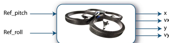
Figura 1. Esquema general de entradas y salidas del AR.Drone 1.0 (La figura pertenece a la referencia [3]).
