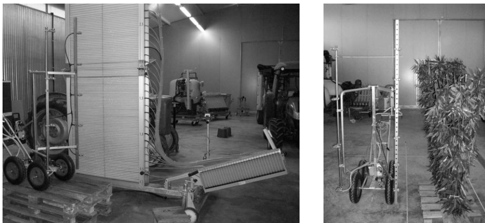
Figura 1. Determinación de la distribución vertical (izquierda) y evaluación de la deposición de la pulverización en vegetación artificial (derecha).
