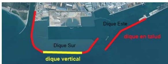
Figura 1. Tipos de diques presentes en el área de estudio. En rojo los diques en talud, y en amarillo los diques verticales o de cajón.
