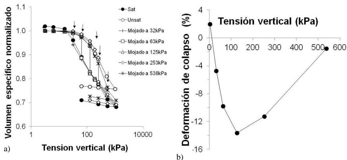
**Figura 2: Resultados de la Series A (baja densidad, condición seca de óptimo); a) mojado bajo carga en el edómetro; b) deformación de colapso a diferentes tensiones verticales.**
