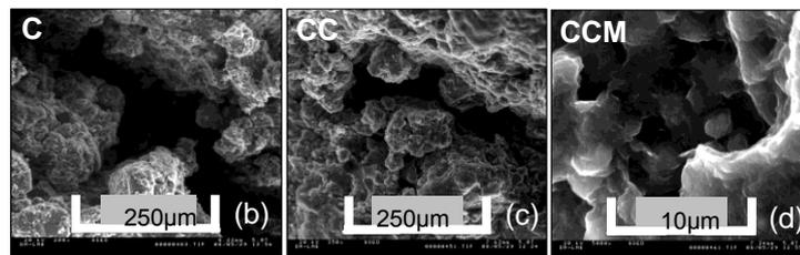
Figura 4: Resultados MIP de muestras: compactadas (C); compactadas y cargadas (CC); y compactadas, cargadas y mojadas (CCM). (a) Distribución de tamaño de poros. (b), (c) y (d) ESEM de las correspondientes muestras.
