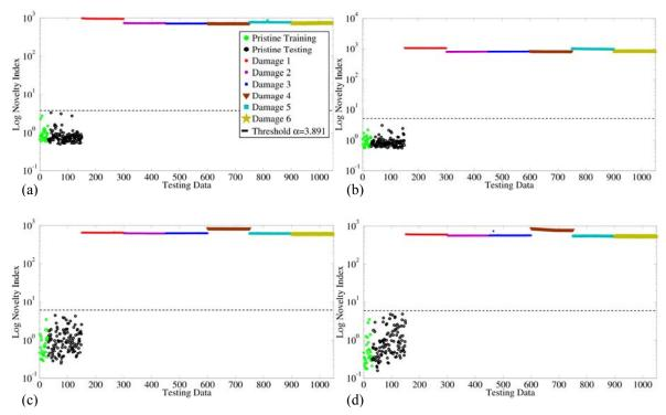
Figure 3. Outlier Analysis by means of PCA : (a) Actuator 1, (b) Actuator 2, (c) Actuator 3, (d) Actuator 4.
