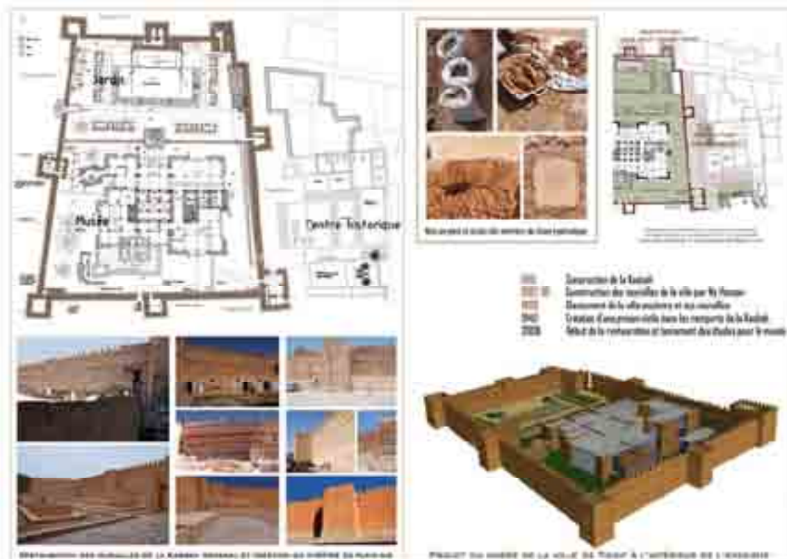
Etapes de la restauration de la Kasbah Aghenaj entre 2008 et 2011, mise au point des enduits de chaux de crépissage
