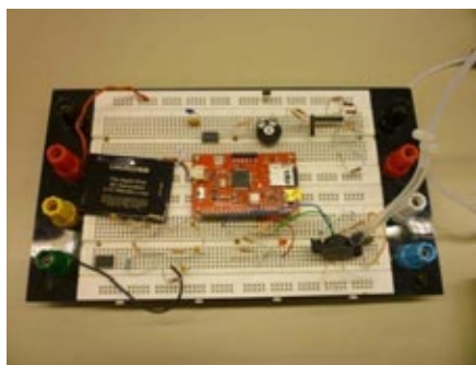
Figura 3: Placa de prototipos con el circuito preliminar y el datalogger (Logomatic V2 de Sparkfun) en el centro.
