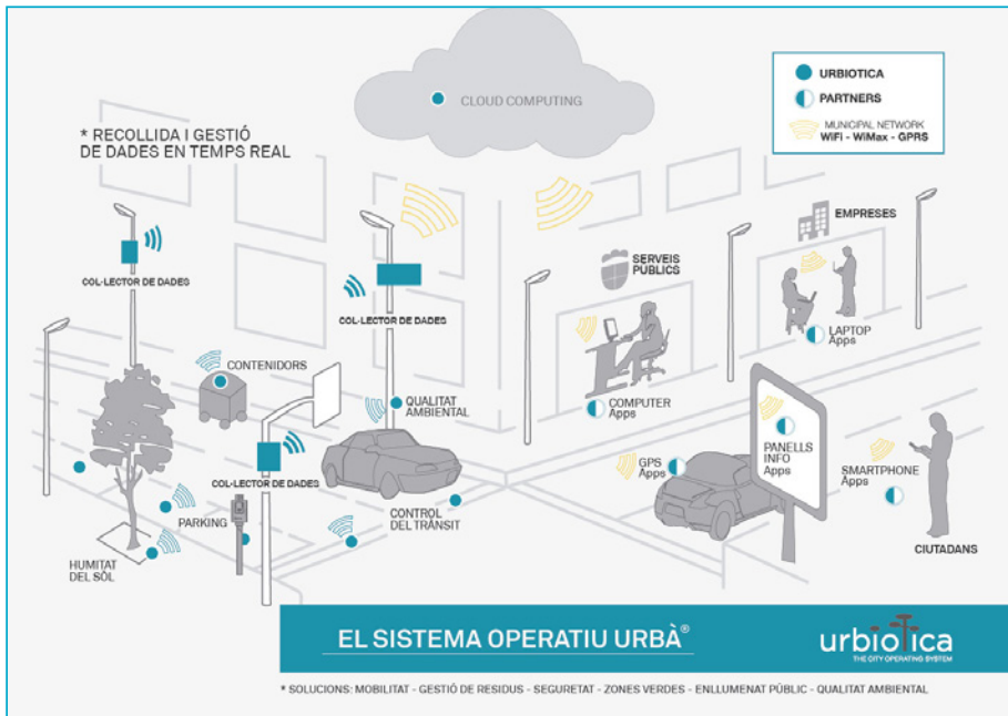
Figura 2: Esquema de funcionament de la xarxa de sensors. Procés de recollida i gestió de la informació, des dels sensors fins a les aplicacions finals.
