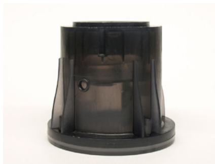
Figura 4: El sensor de pas de vehicles i d'aparcament desenvolupat per URBIOTICA pel control del trànsit.
