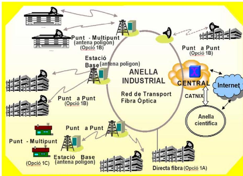
Figura 3. Estructura de comunicaciones definida como *Anillo Industrial*
