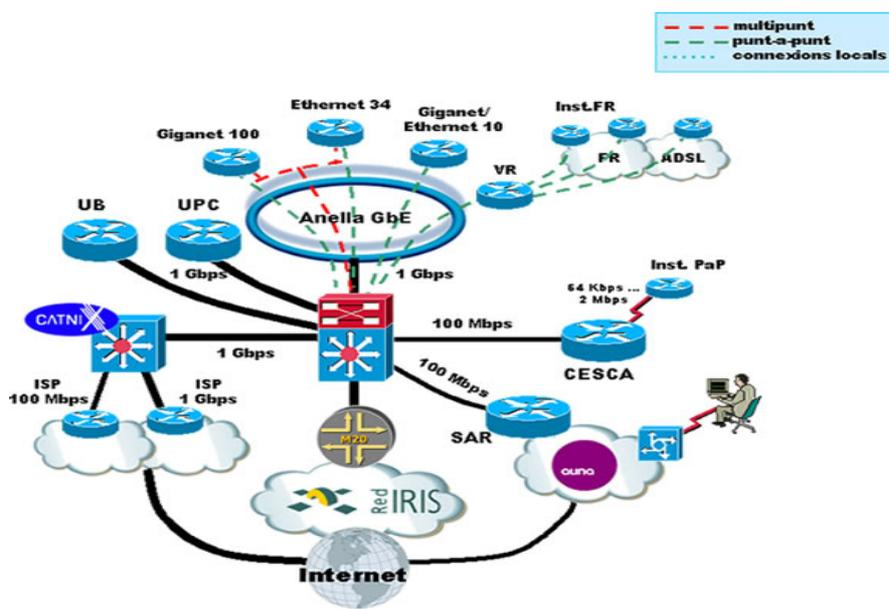
Figura 2. Estructura de comunicaciones de la Anella Científica
