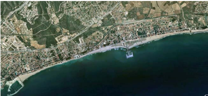
Figura 9. Efecto barrera al transporte longitudinal de sedimento del puerto deportivo de Roda de Barà (abajo) y puerto de Coma-ruga (centro) (fuente: Google Earth).
