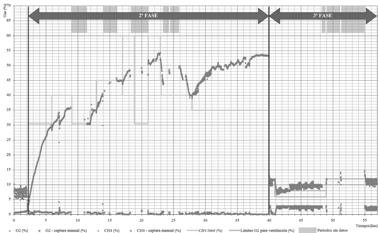
Figura 3. Evolución de las concentraciones de O 2 y CH 4 en la fase gaseosa del reactor durante el tratamiento de estiércol de bovino en planta piloto.
