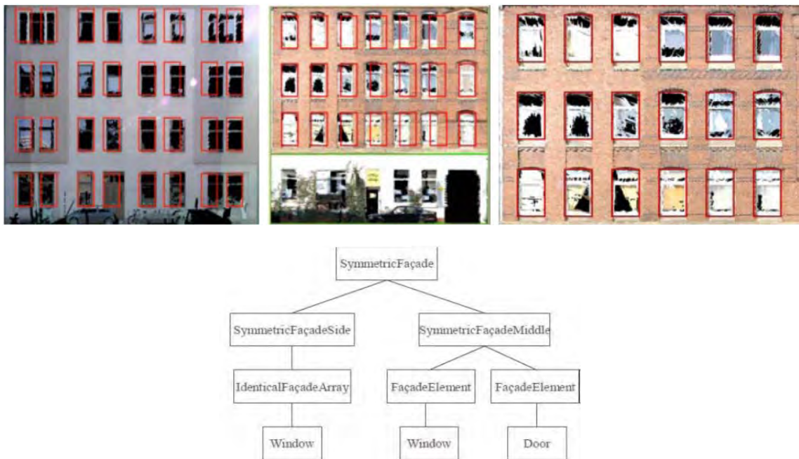
Figura 8: Detección de elementos repetitivos de las fachadas (ventanas) y la estructura del modelo procedural
