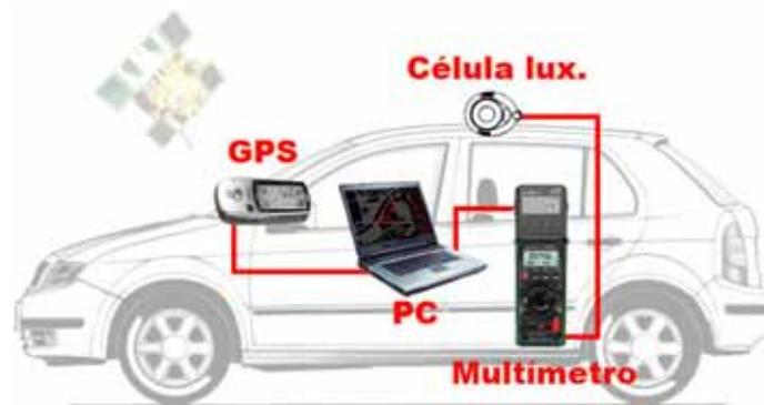
Para la primera versión comercial se conservó los requerimientos para el vehículo y el ordenador, pero se decidió dar un enfoque diferente para los sensores y se optó por crear un único modulo con conexión USB que integrara la célula luxométrica y GPS en un mismo cuerpo y que pudiera ser alimentado por el propio cable USB. Los motivos para esto fueron:
