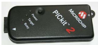
Fig. 6.- Programador PICKit™ 2 de la firma Microchip®, para la programación de la plataforma docente llevada a cabo.
