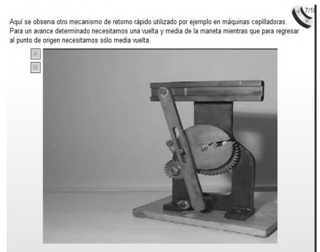
Figura 11. Máquinas Reales. Mecanismo Retorno rápido.
