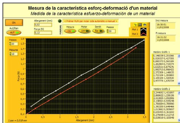
Figura 4. Set-up y panel de control de la medida de la característica esfuerzo-deformación de un polímero
