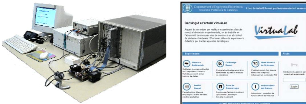
**Figura 1.** Laboratorio remoto Virtualab basado en un equipo VXI.
