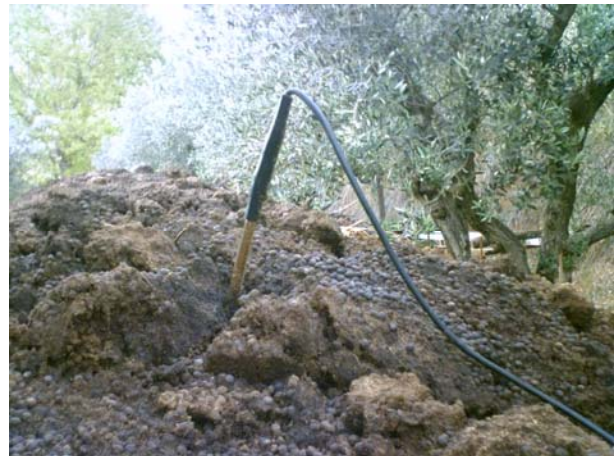
Foto 9. Ventilador y sistema de control del compostaje de estiércol de conejo (granja Can Fornés - les Franqueses del Vallès) (foto de la izquierda). La ventilación está temporizada y termostatada. La temperatura se determina mediante una sonda clavada en el material (foto de la derecha). Cuando supera la temperatura preestablecida —60 °C en este caso—, la ventilación se mantiene en funcionamiento hasta lograr rebajarla.
