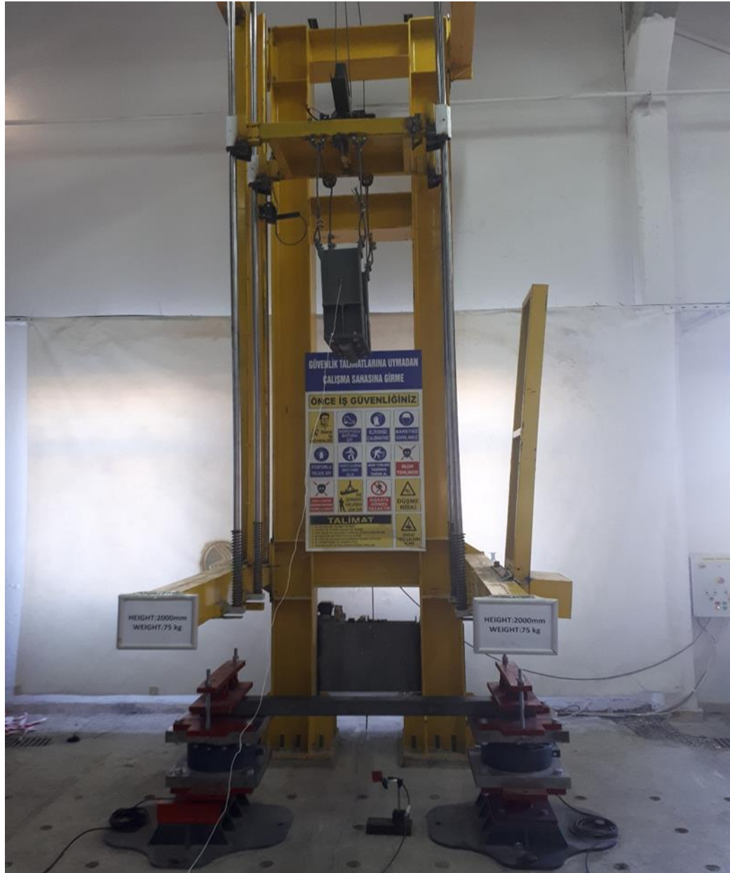
Şekil 4.8. 2000 mm yükseklikten uygulanan darbe deneyi düzeneği
