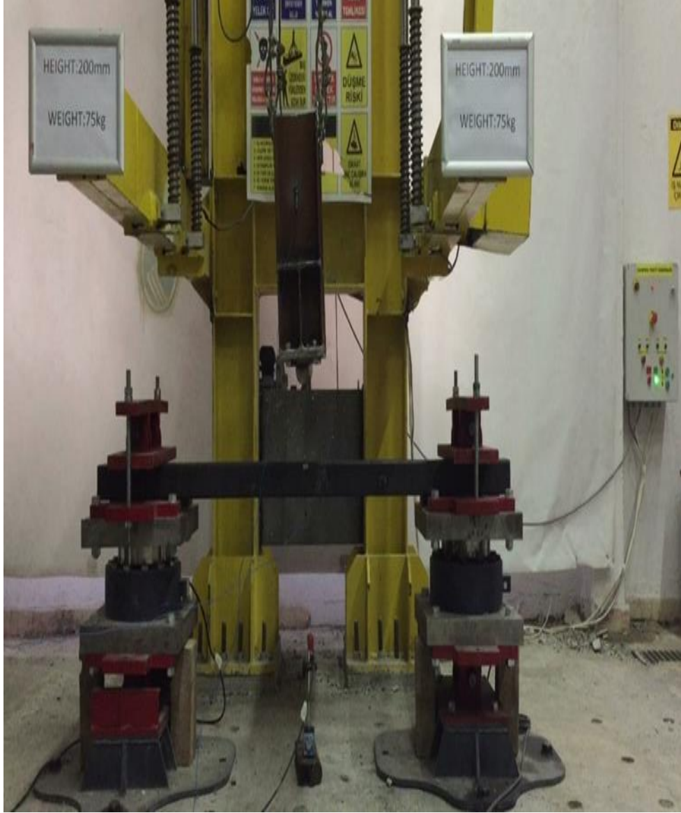
Şekil 4.1. 200 mm yüksekliğe ait darbe deneyi düzeneği
