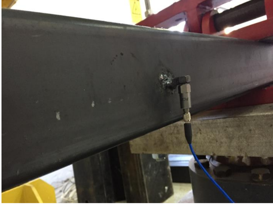
Şekil 3.16. Deney düzeneğindeki numunede bulunan ivmeölçer
