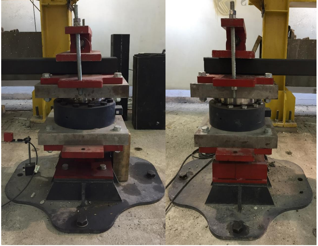
Şekil 3.13. Sabit ve hareketli mesnet
