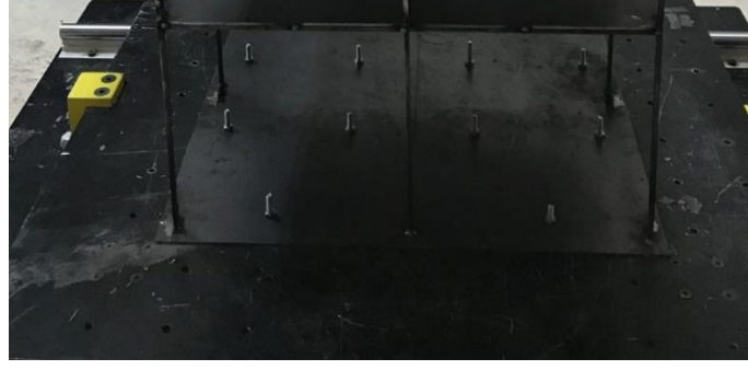
Şekil 3.19. Model yapıların sarsma tablasına bulonlar ile sabitlenmesi
