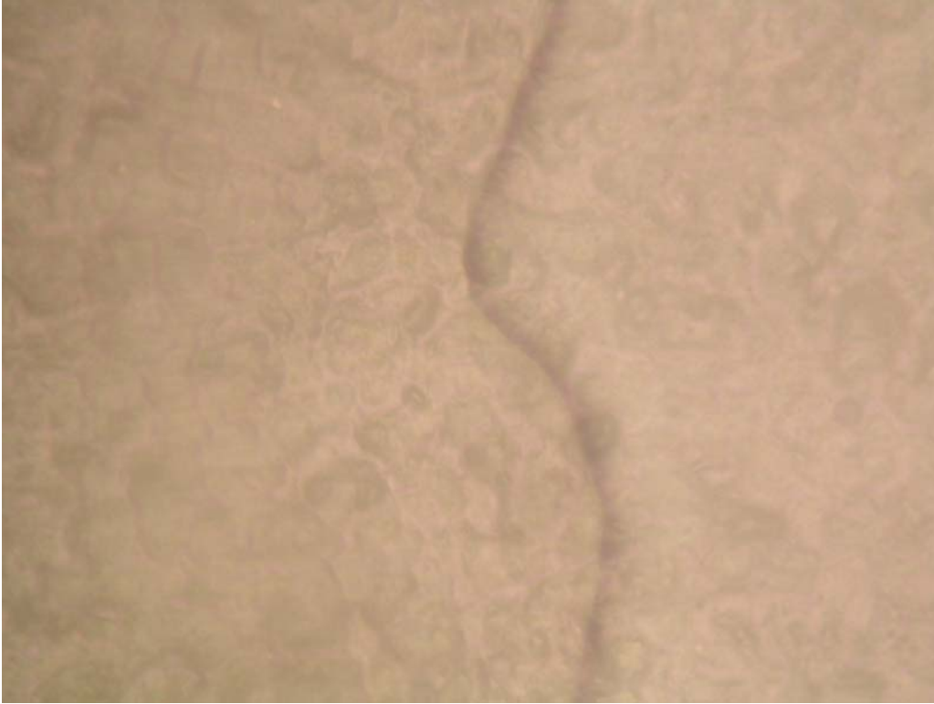
Şekil 6.6. PC filmin cam ile sınır çizgisi halindeki mikroskop görüntüsü
