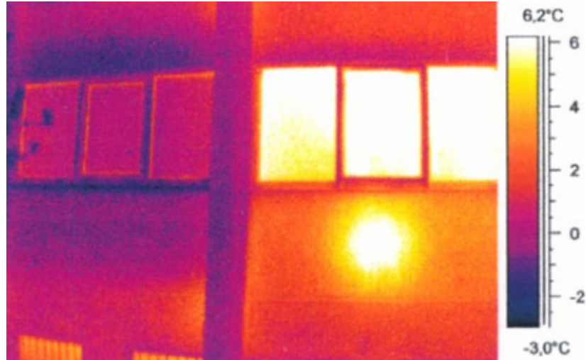
Şekil 3.12. Duvarlarda Isı Yalıtımının Isı Kaybını Engellemedeki Rolü
