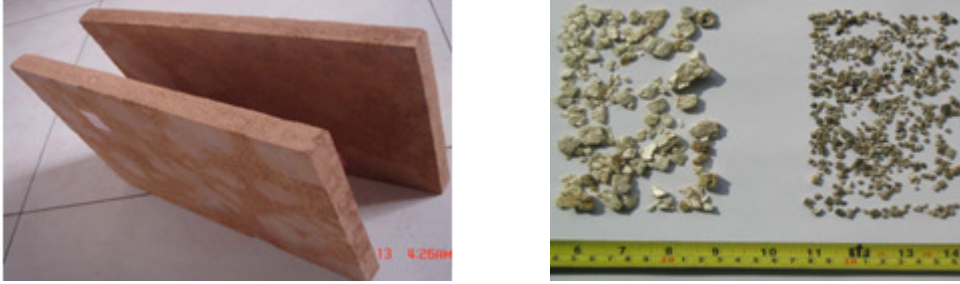
Şekil 2.10. Vermüsilite Yalıtım Malzemesinin Tanecikli Hali ve Levha Hali
