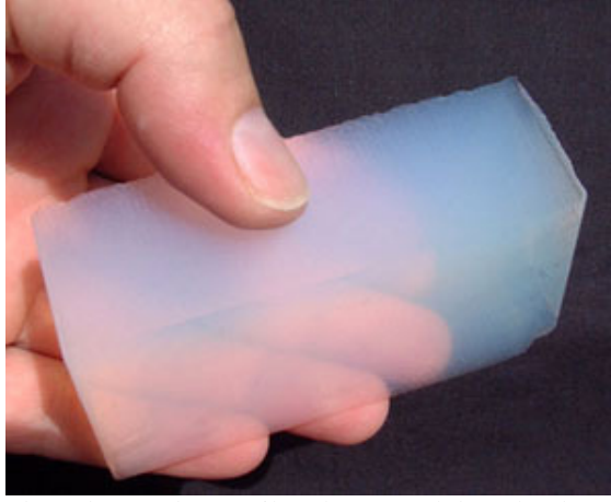
Şekil 2.32. İçinde Çok Küçük ve Milyonlarca Boşluk Bulunduran Dünyanın Varolan En Hafif Katı Maddesi Silika Aerojel
