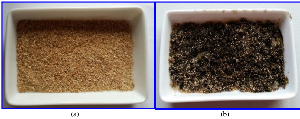
Şekil 3.5. Odun talaşı (a) ve odun talaşı-atık yağ (b) karışımının konulduğu geniş krozeler
