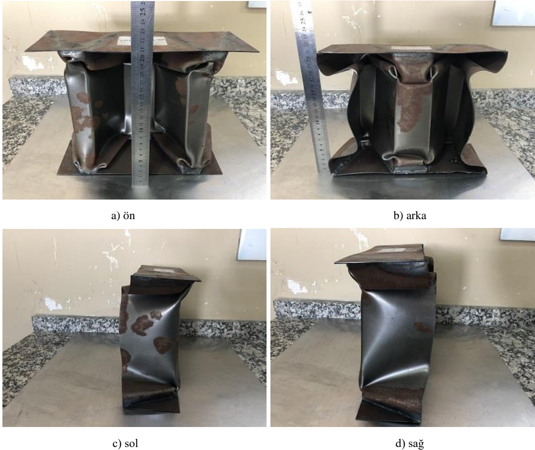
řekil 4.37. W01-I1.2-S01-T05 kodlu numunenin arpıřma testi sonrası durumu
