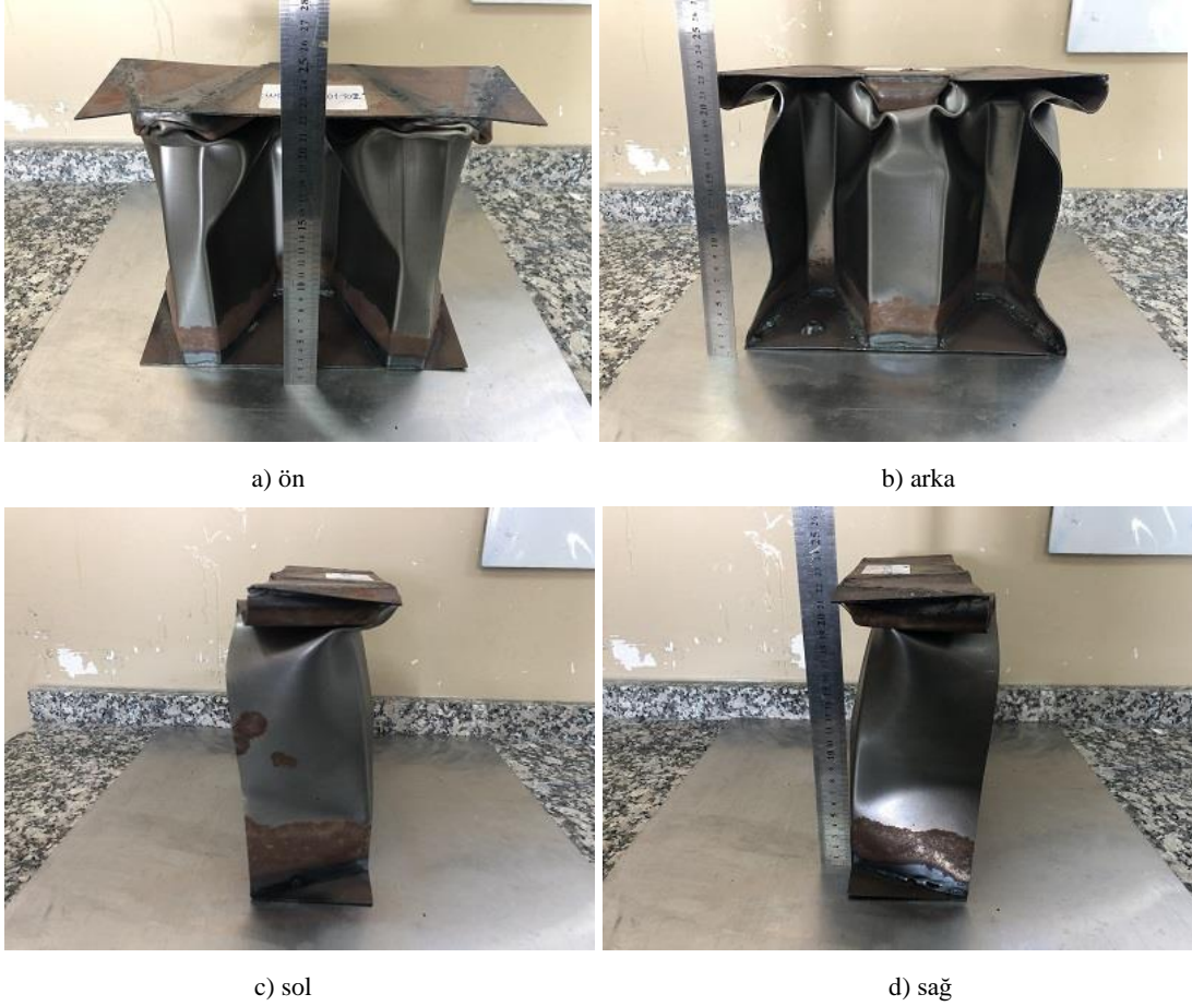
Şekil 4.34. W01-I1.2-S01-T02 kodlu numunenin çarpışma testi sonrası durumu
