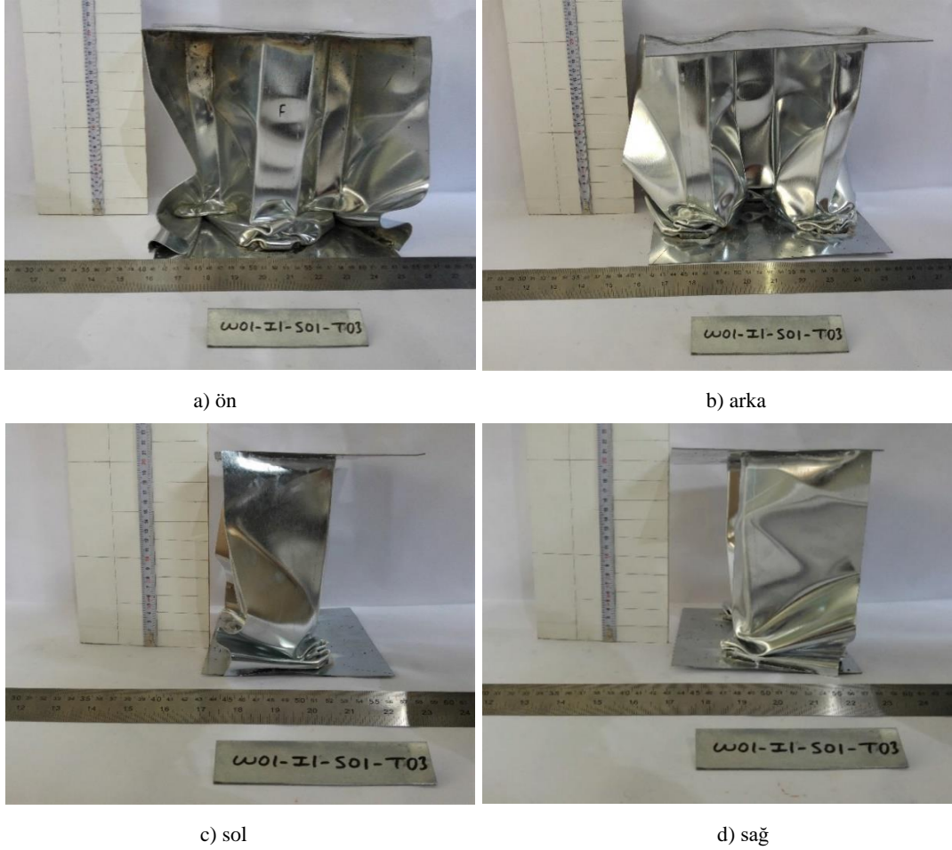
Şekil 4.11. W01-I1-S01-T03 nolu numunenin çarpışma sonunda ki ölçüleri
