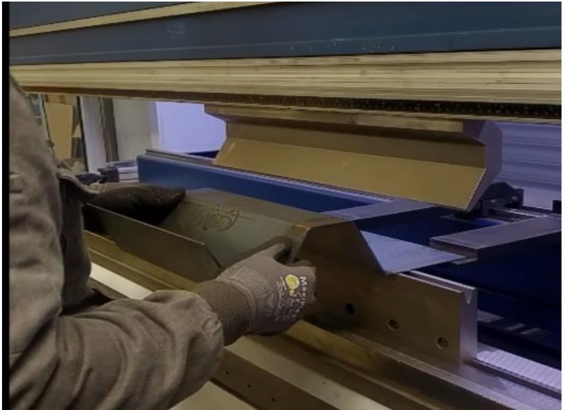
Şekil 2.4. W profil kesitine sahip numunenin abkant tezgahında büküm işlemlerinin gerçekleştirilmesi
