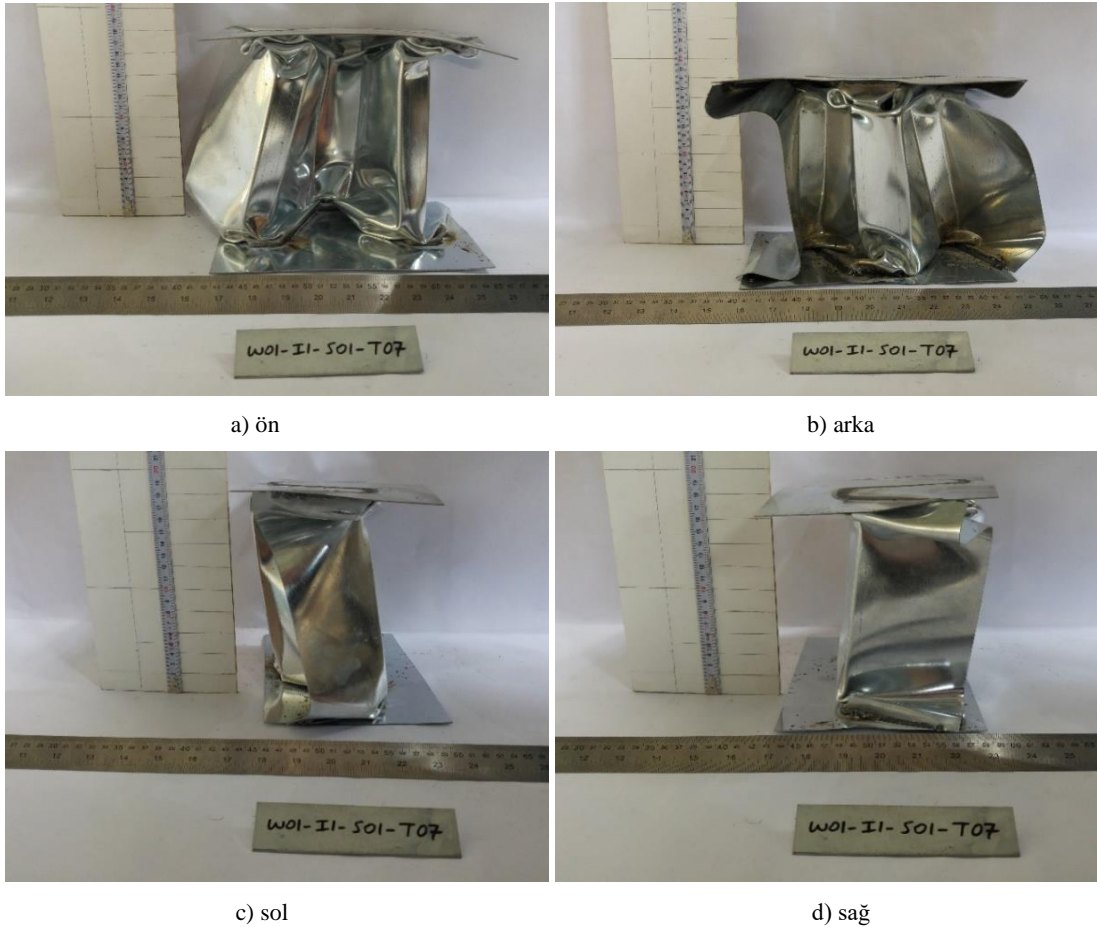
Şekil 4.19. W01-II-S01-T07 kodlu numunenin çarpışma testi sonrası durumu
