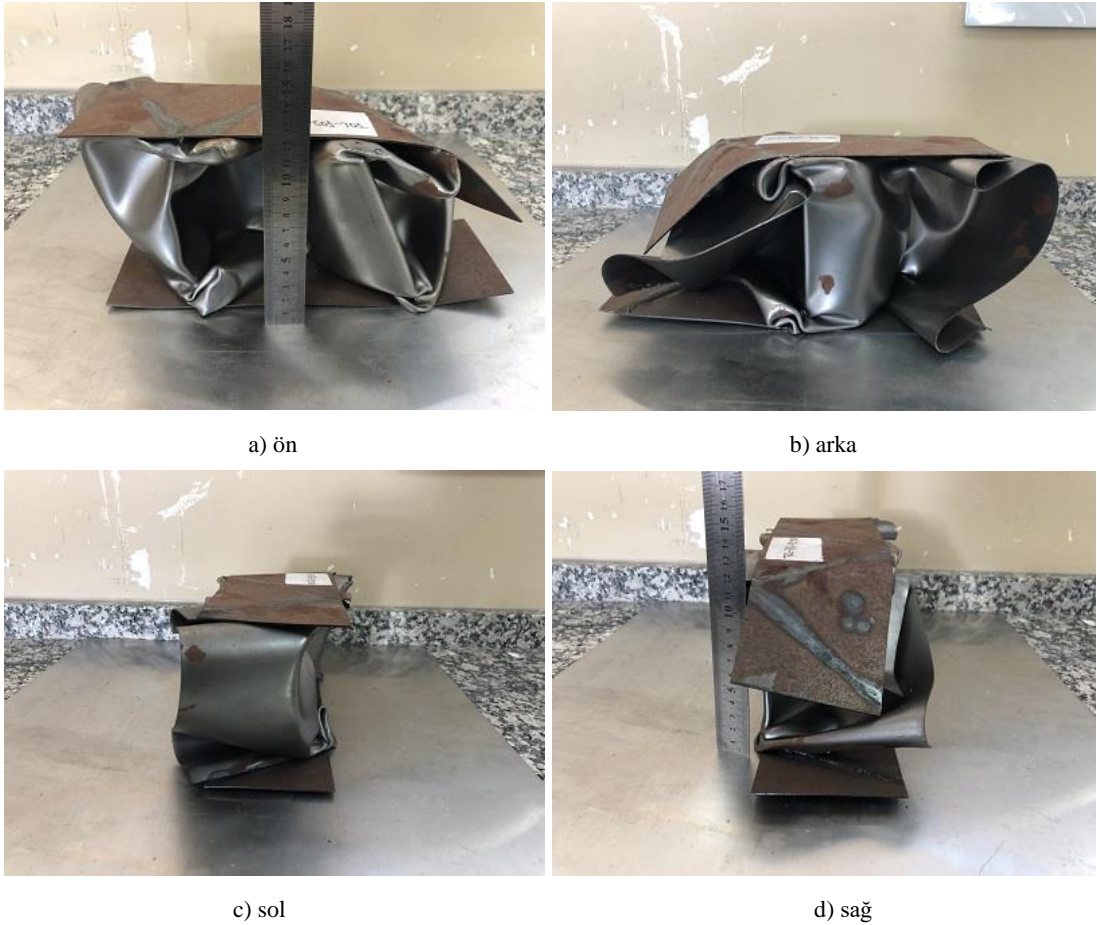
Şekil 4.25. W02-II-S01-T01 kodlu numunenin çarpışma testi sonrası durumu
