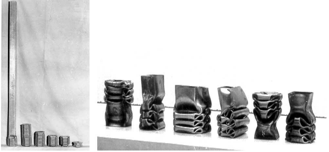
Şekil 1.6. Çoğunlukla aksenal çarpma yüklemesine tabi tutulan düzgün tetiklenmiş prizmatik elemanların aşamalı katlanması
