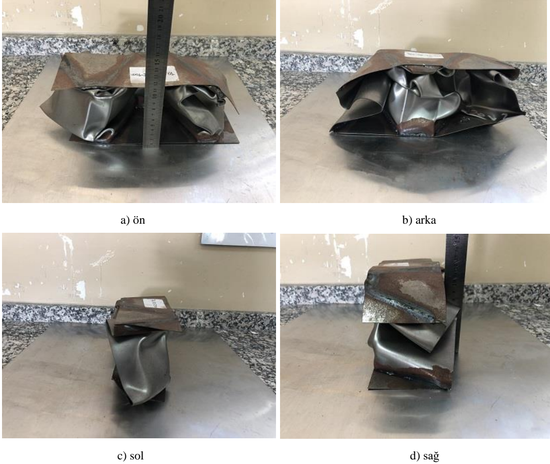
Şekil 4.22. W01-II-S02-T01 kodlu numunenin çarpışma testi sonrası durumu
