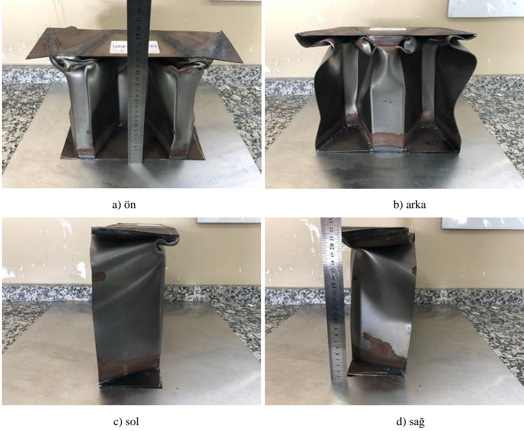
Şekil 4.33. W01-I1.2-S01-T01 kodlu numunenin çarpışma testi sonrası durumu
