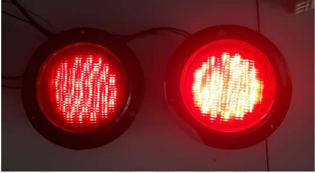
Şekil 7.5. Mevcut Tasarım (Sol) Ve Yeni Tasarım (Sağ) İşaret Lambaları
