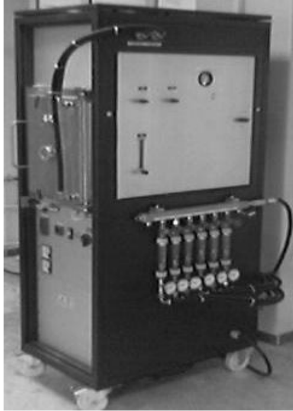
Şekil 6.4. Deneylerde kullanılan kutu tipi fırın.
