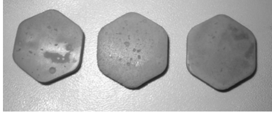
Şekil 7.1. 1700°C`ta 1 saat sinterlenen seramik tabletlerin sinter sonrası görüntüleri.
