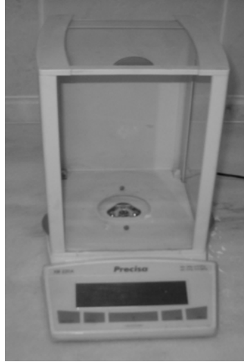
Şekil 6.5. Yoğunluk ölçümlerinde kullanılan Precisa XB220A model tartı
