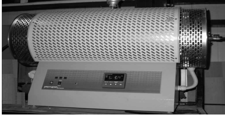
Şekil 6.3. Deneylerde kullanılan tüp fırın
