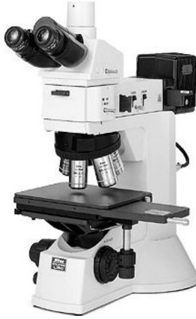
Şekil 6.6. Mikroyapı incelemelerinde kullanılan Nikon Eclipse L150 model optik mikroskop
