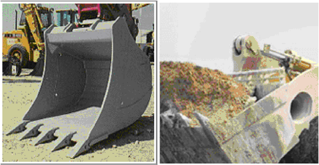
Şekil 3.2. Hardox aşınma levhasından imal edilmiş kepçeler
