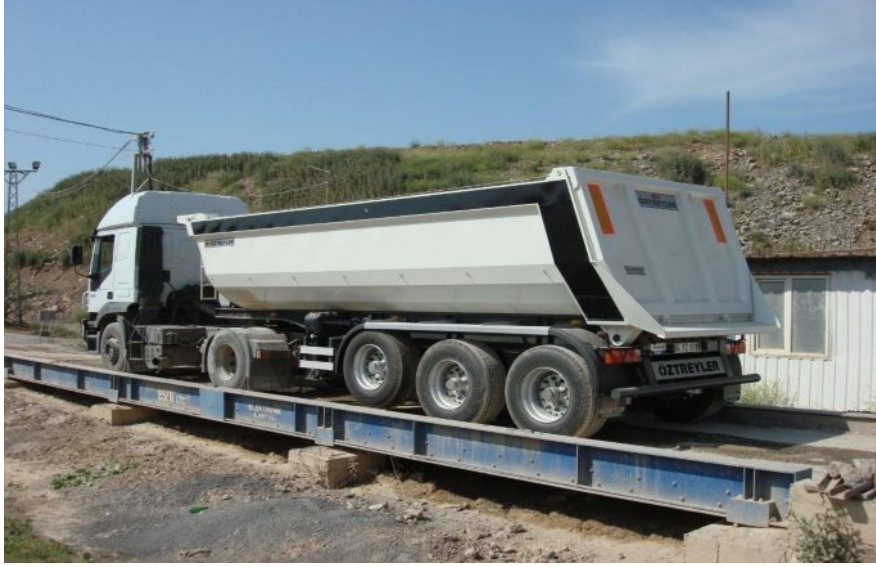
Şekil 3.3. HARDOX aşınma levhasından imal edilmiş yarım boru tipi damper kasa
