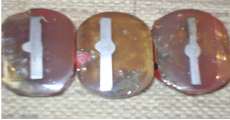
Şekil 4.4. Mikroyapı incelemesi için bakalite alınmış kaynaklı numuneler
