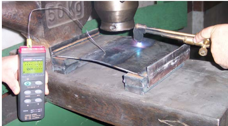
Şekil 3.20. Thermocouple cihazı ile ölçüm yapılması
