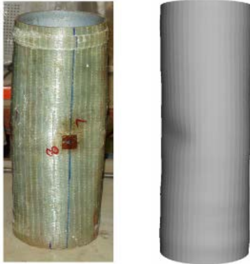
Şekil 2.11. Dairesel kesitli kolonlara GFRP eklenmesi [32]
