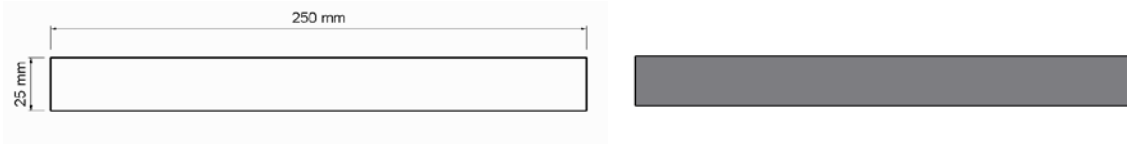
Şekil 3.5. GFRP çekme deney numune boyutları
