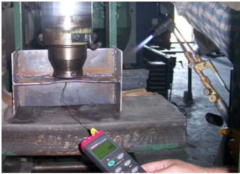
a. Isıl işlem ve thermocouple ile ölçüm alınması
