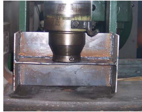
b. Isıl işlem sonrası elemanın preslenerek düzeltilmesi
