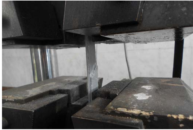
Şekil 3.6. GFRP çekme deneyi
