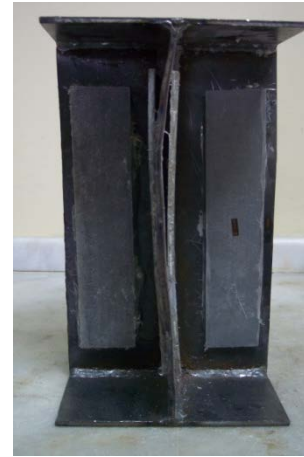
Şekil 5.18. GFRP ve CFRP ile güçlendirilen çelik plakaların deney ve SEM sonuçlarının karşılaştırılması
