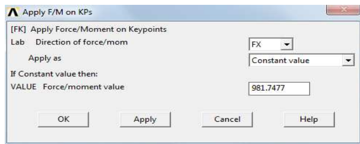
Şekil 4.22. Kuvvetin uygulanacađı keypointin seęilmesi, yönünün ve deęerinin girilmesi.
