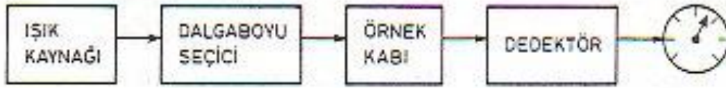
Şekil 2.11. UV-GB spektrofotometresinin şematik gösterimi
