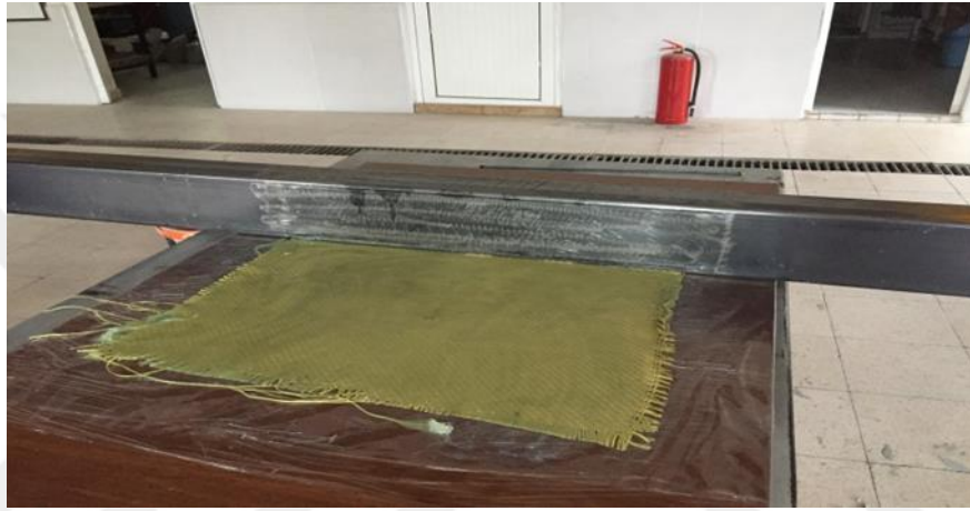
Şekil 3.6. Aramid fiberin profile yapıştırılması
