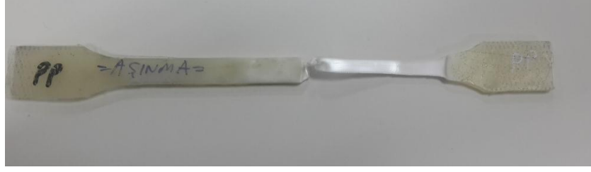
Şekil 4.5. Saf PP polimerin çekme deneyi sonrasındaki görüntüsü
