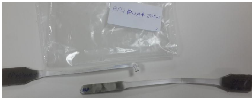
Şekil 4.11. PP-g-MA modifiyeli ve %20 Bor minerali atığı katkılı PP polimer kompozitin çekme deneyi sonrasındaki görüntüsü
