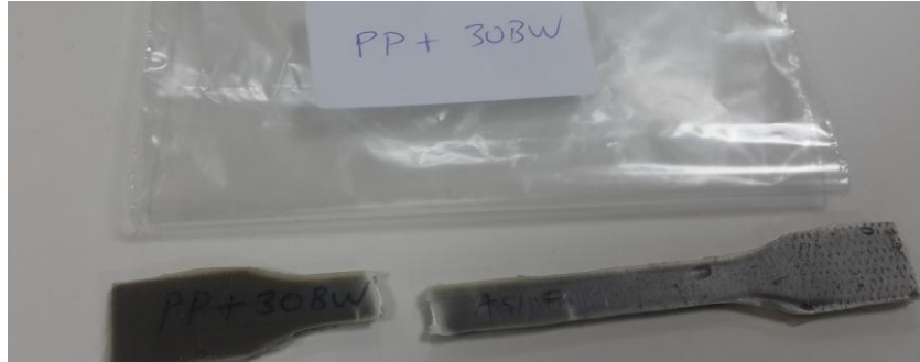
Şekil 4.8. %30 Bor minerali atığı katkılı PP polimer kompozitin çekme deneyi sonrasındaki görüntüsü
