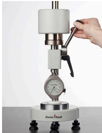
Şekil 4.16. Sertlik ölçüm cihazı
