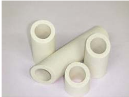
Şekil 3.7. Kordiyerit seramiklerden üretilen su filtreleri [60]
