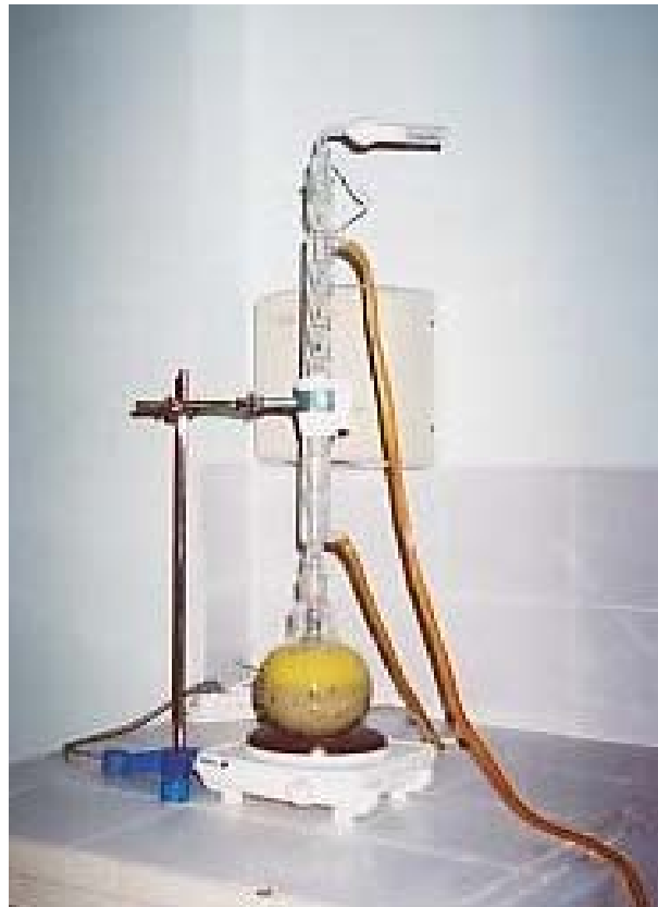
Őekil 6.3. Kimyasal aktivasyon iřlemi deney düzeneęi
