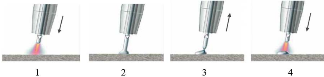
Şekil 4.1. CMT kaynak yönteminde oluşan entegre tel hareketi [27].
