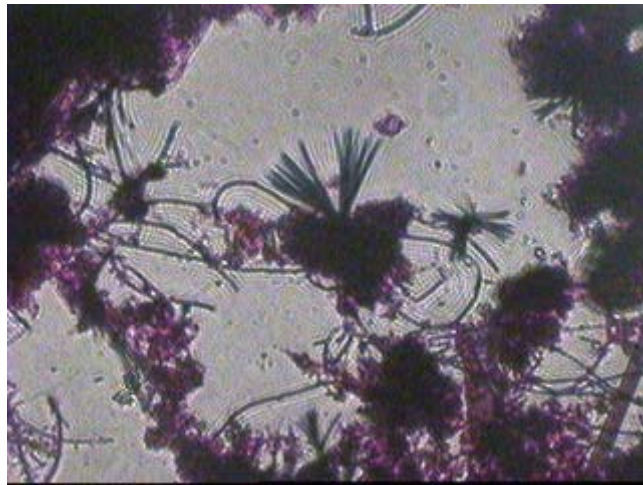
Resim 7.47. 05.04.07 tarihli numuneden Aktinomisetle M. parvicella 'nın birlikte bulunmasına bir örnek (Gram boyama, 100x)
