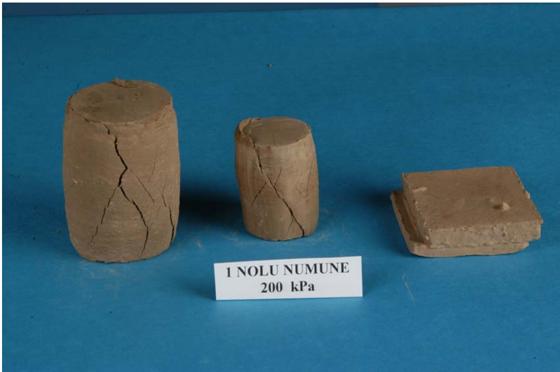
Şekil 4.2. "1" no'lu numunenin 200 kPa hücre basıncı ve normal gerilme ile kesildikten sonraki görünümleri
