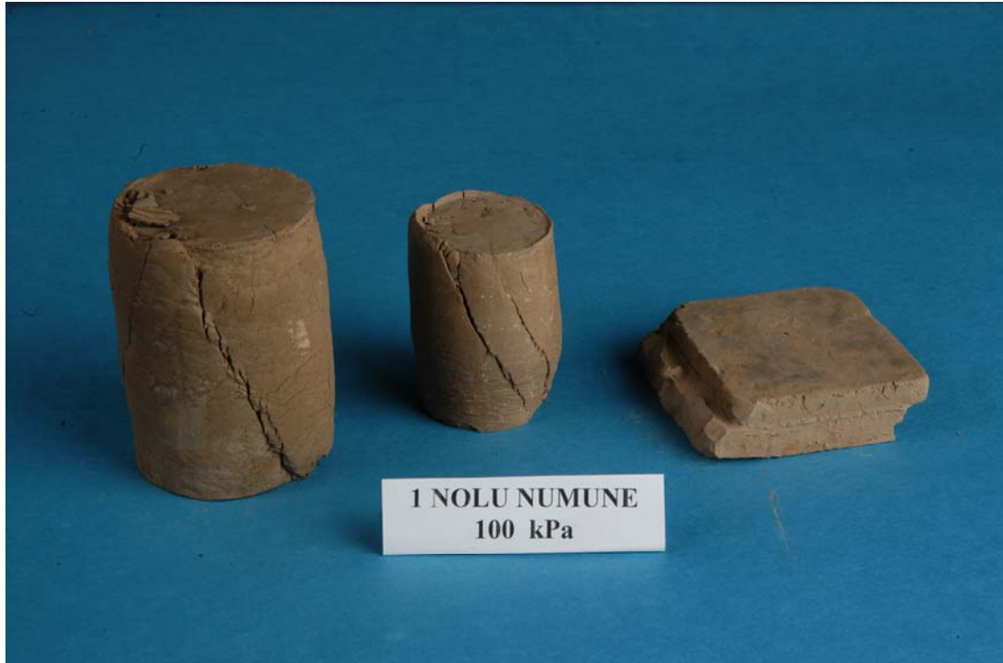
Şekil 3.23. Üç eksenli basınç deneyi ve kesme kutusu ile kırılmış numuneler
