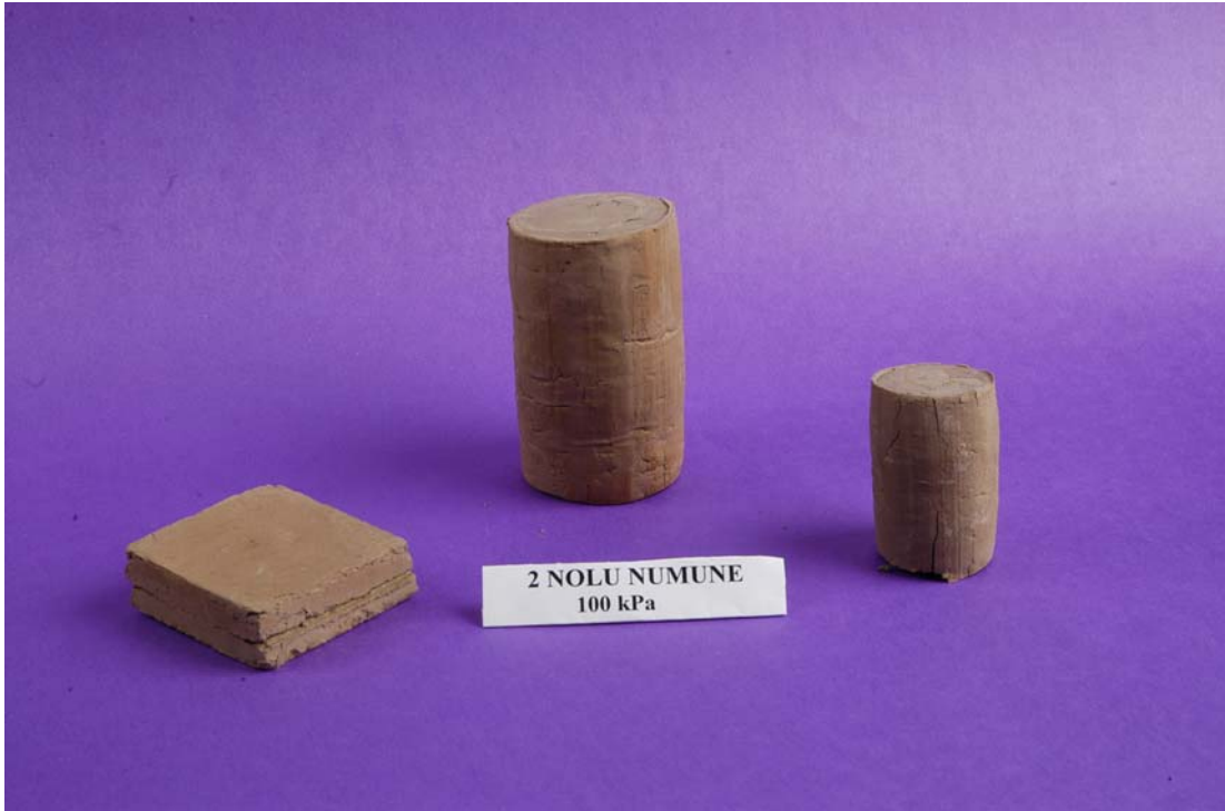
Şekil 4.3. "2" no'lu numunenin 100 kPa hücre basıncı ve normal gerilme ile kesildikten sonraki Görünümü
