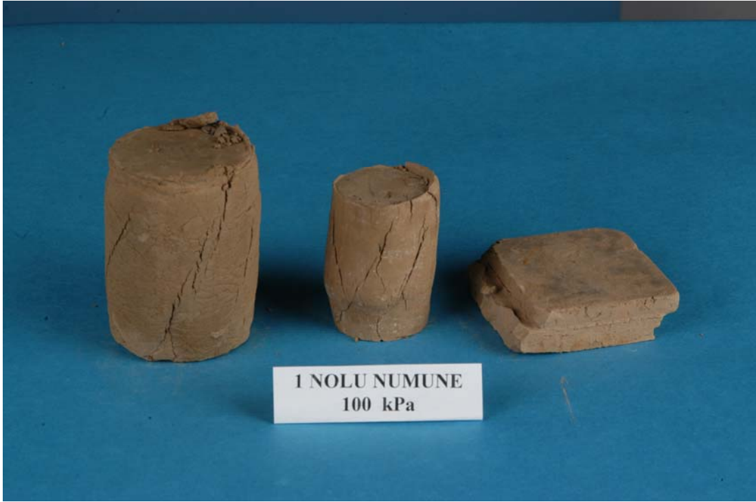
Şekil 4.1. "1" no'lu numunenin 100 kPa hücre basıncı ve normal gerilme ile kesildikten sonraki görünümleri
