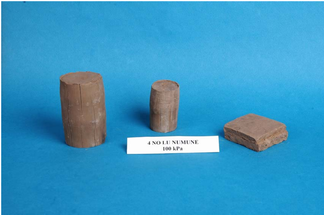
Şekil 4.4. "4" nolu numunenin 100 kPa hücre basıncı ve normal gerilme ile kesildikten sonraki görünümü
