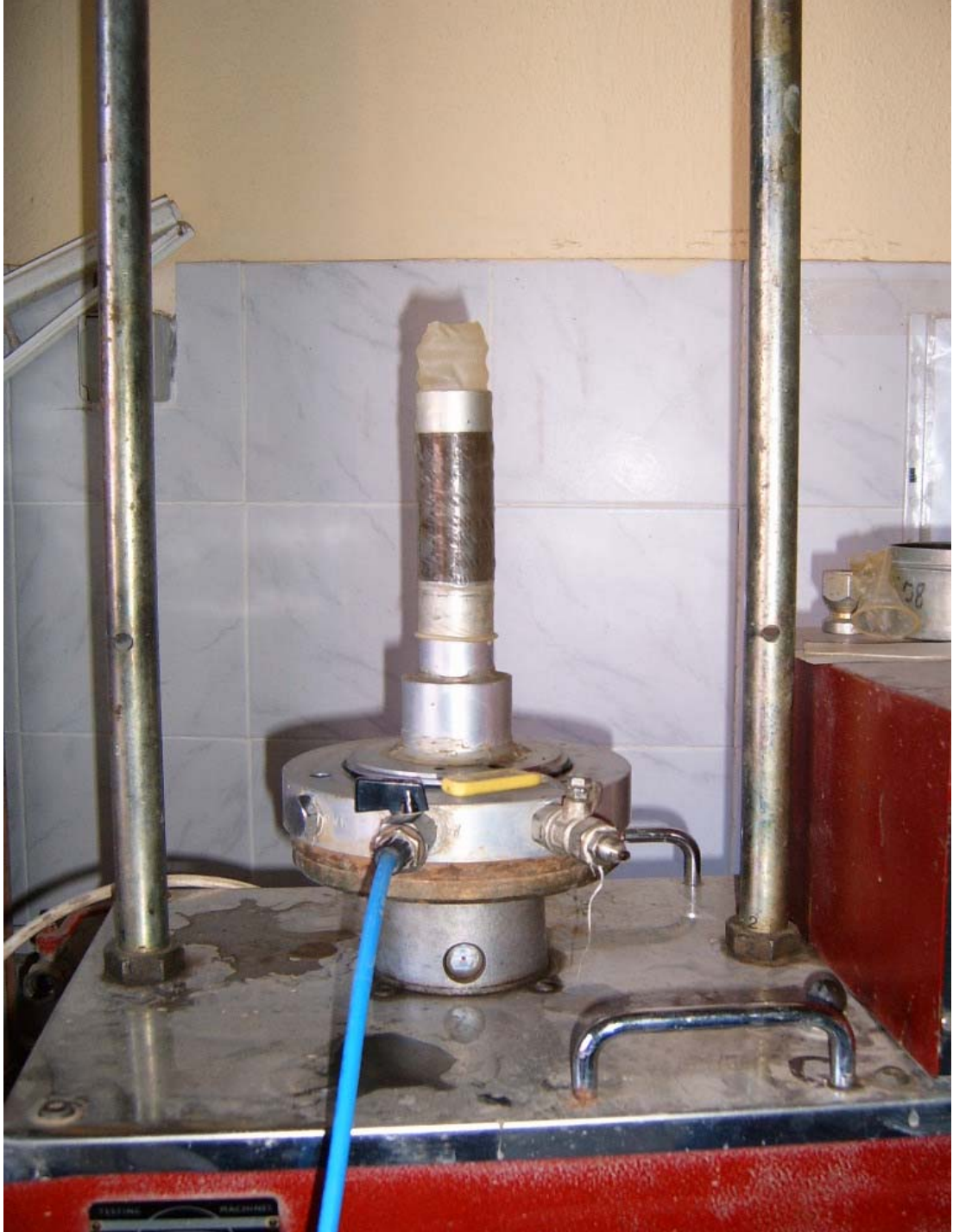
Őekil 3.20. ű aksenli basın cihazına numunenin űzerine membran geirilerek yerleŐtirilmiŐ hali
