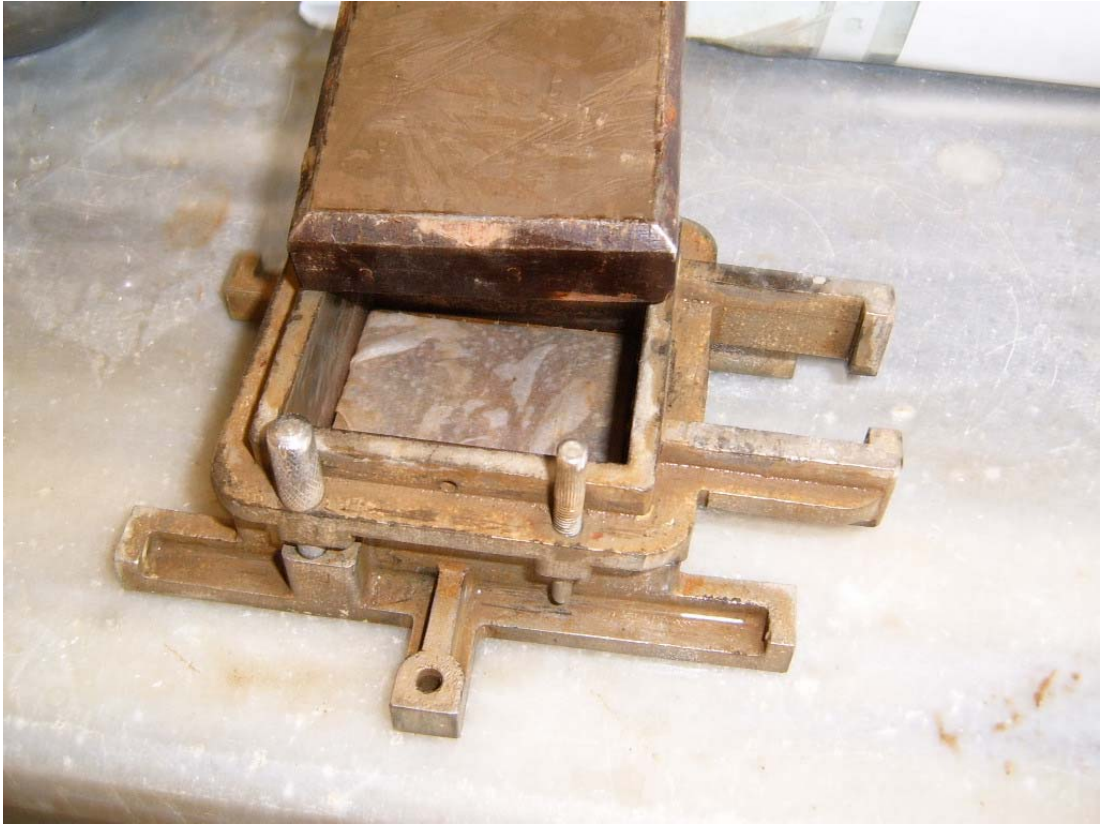
Şekil 3.12. Kesme kutusu ve numunenin kutuya konmadan önceki hali
