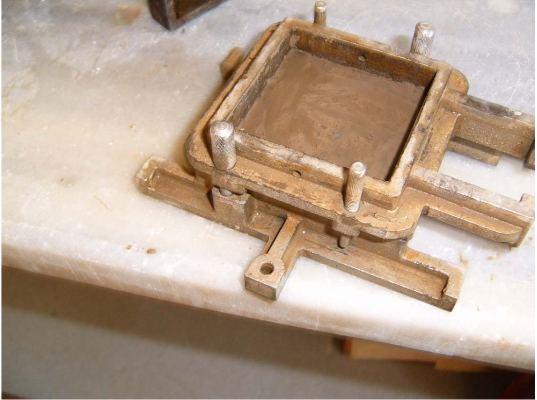
Şekil 3.13. Numunenin kesme kutusuna yerleştirilmiş hali
