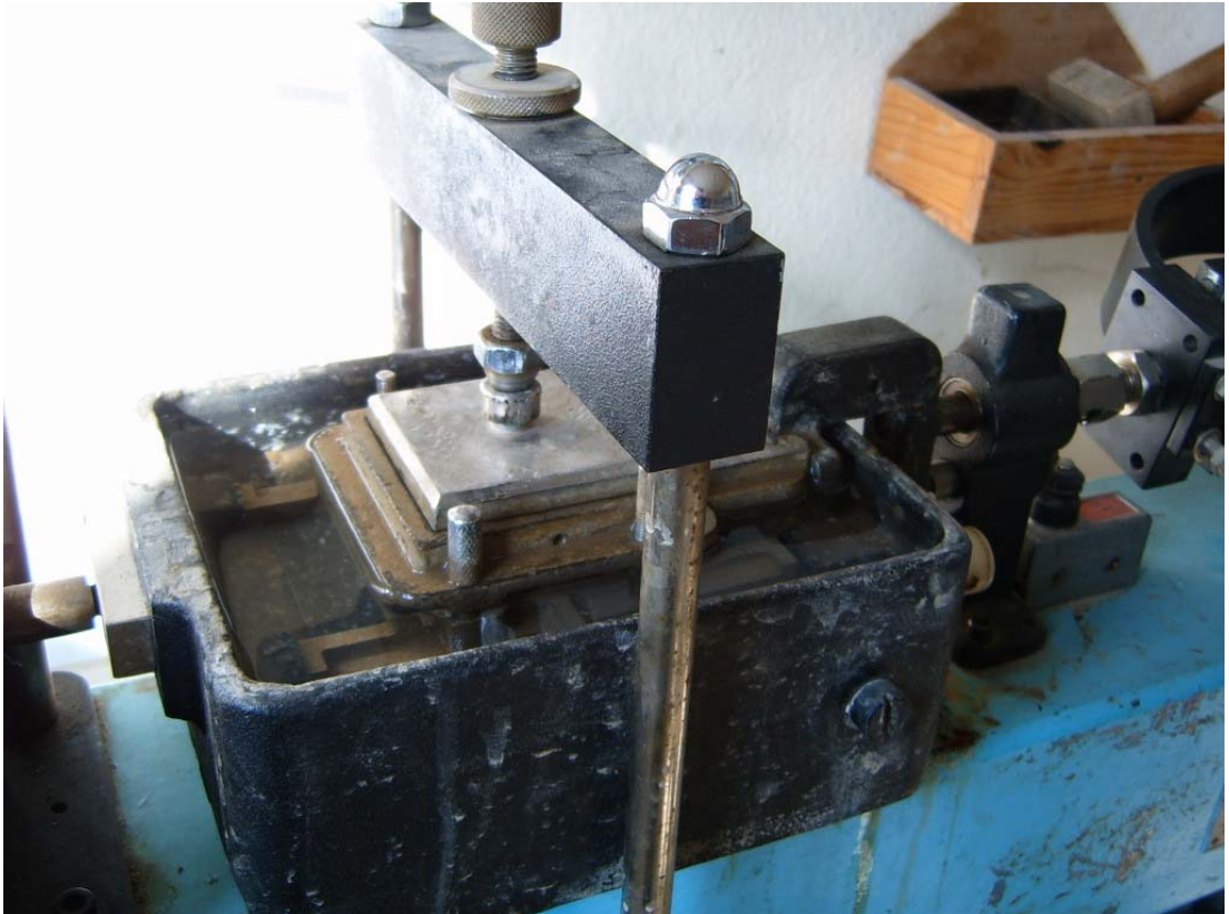
Şekil 3.14. Kesme kutusunun deney sistemine yerleştirilmiş hali
