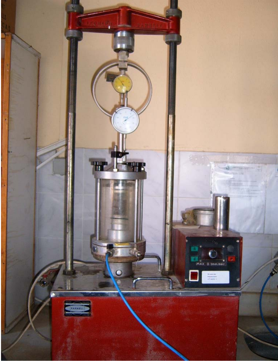
Şekil 3.21. Üç eksenli basınç cihazında numunenin kesilmeye hazır hali
