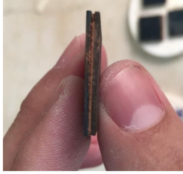
Şekil 4.15. Isıl işlem sonrası sandviç panel
