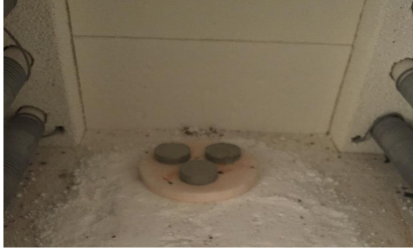
Şekil 4.5. A1, A2 ve A3 bileşimlerinden XRD incelemesi için 1000°C’de 1 saat ısıtım işlem uygulanan sinter numuneler
