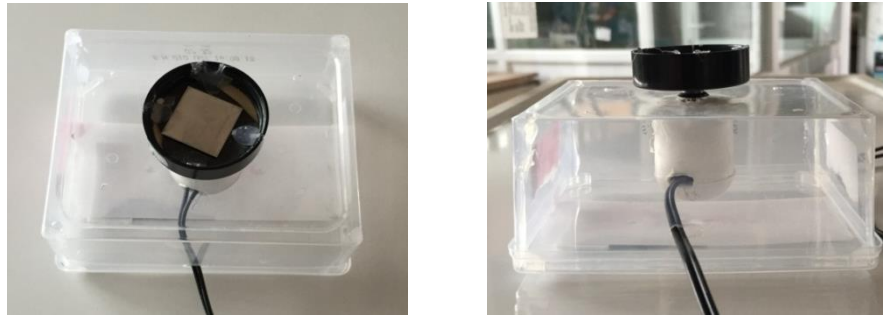
Şekil 4.8. Spin kaplamada kullanılan basit düzenek
