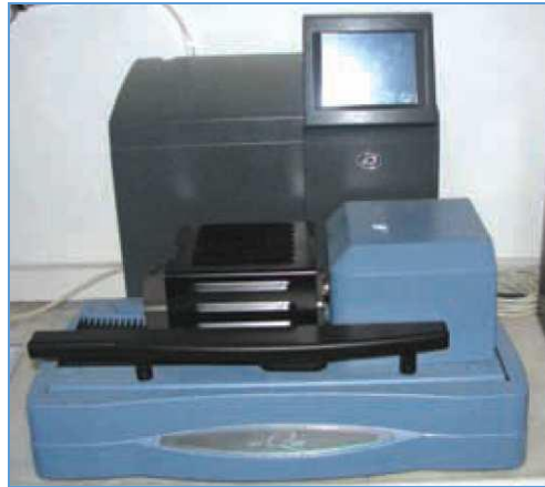
Şekil 4.4. Termal analizlerde kullanılan DTA cihazı
