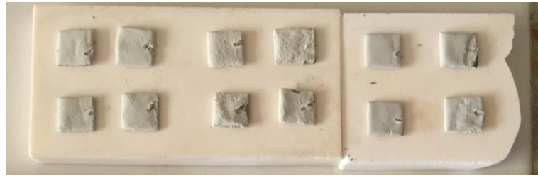
Şekil 4.13. B Grubu kurutma işlemi sonrası kaplanmış numuneler
