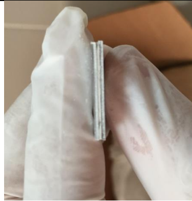
Şekil 4.14. ıslıl işleme hazır kaplanmış sandviç panel
