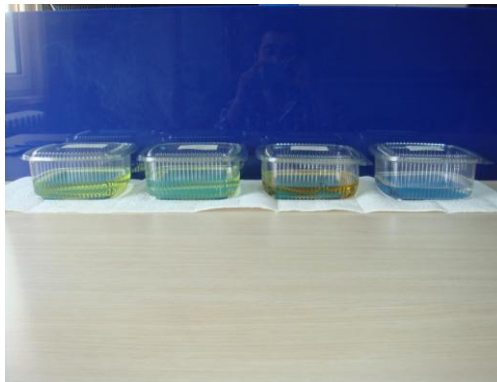
Şekil 5.18.Banyo testi için hazırlanmış test ortamları
