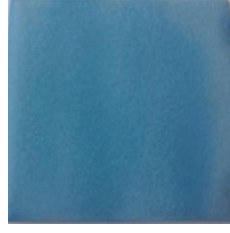
Şekil 6.37. EVA+ TiO 2 tozunun alev spray ile kaplanmış numunesinin makro görüntüsü
