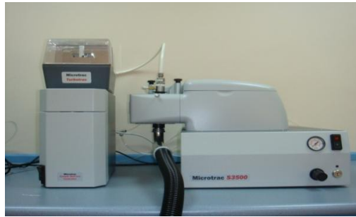
Şekil 5.3. Toz partikül boyut ölçümünde kullanılan Microtrac S3500 marka lazerle partikül boyut ölçme cihazı.
