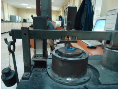
Şekil 5.17. Aşınma deneyi test düzeneği
