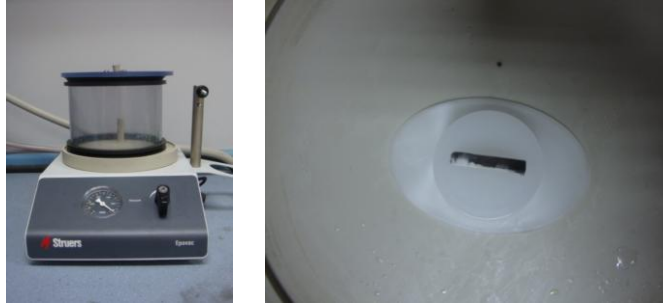
Şekil 5.7. Soğuk bakalite alma işleminin gerçekleştirildiği Struers Evopac marka vakum alma cihazı
