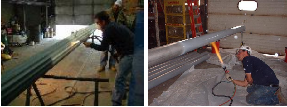
Şekil 3.8. Alev sprej yöntemiyle bakımı zor olan direklerin polimer kaplanması [18]
