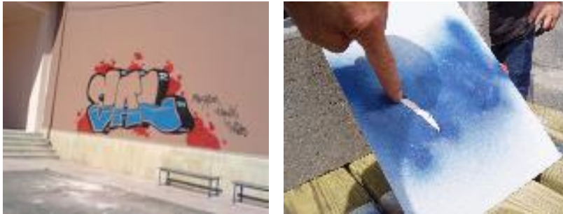
Şekil 3.11. Alev sprey yöntemiyle üretilen polimer kaplamanın boyanmazlık özelliği [17]
