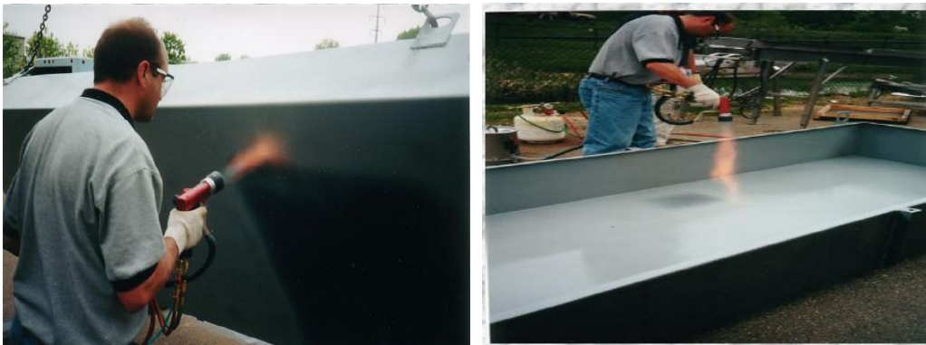
Şekil 3.9. Alev sprej yöntemiyle polimer kaplama uygulamaları [18]
