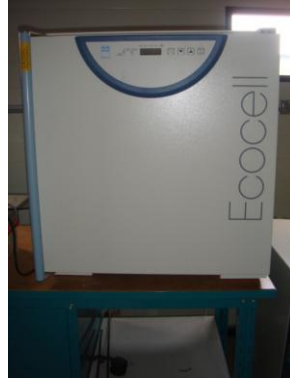
Şekil 5.2. Toz bünyesinde nemi uzaklaştırmak için kullanılan EcoCell marka kurutma fırını (etüv).
