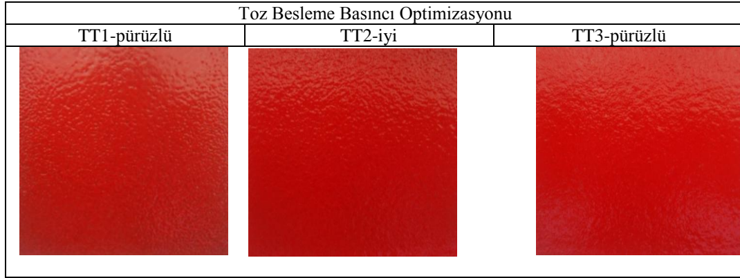
Şekil 6.8. Taşıyıcı toz besleme basıncına göre üretilen numunelerin makro görüntüleri
