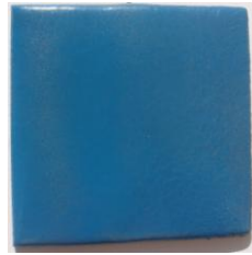
Şekil 6.27. EVA+ % 10 SiC tozunun alev sprey ile kaplanmış numunesinin makro görüntüsü
