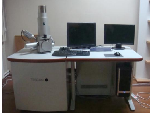
Şekil 5.10. TESCAN marka taramalı elektron mikroskobu (SEM).
