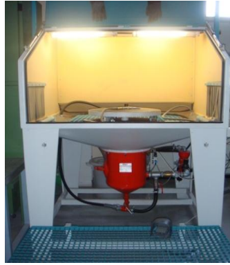
Şekil 5.1. Altlık malzemesinin kumlanması için kullanılan SAPI marka basınçlı kumlama makinesi.
