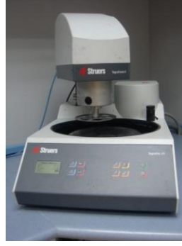
Şekil 5.8. Zımparalama ve parlatma işleminin yapıldığı Struers TegraPol-21 marka otomatik zımparalama ve parlatma cihazı
