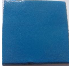
Şekil 6.32. EVA+ %10 Al 2 O 3 tozunun alev sprej ile kaplanmış numunesinin makro görüntüsü
