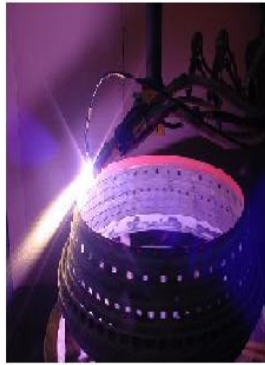
Termal etkilere karşı koruyucu ZrO_2+Y_2O_3 kaplamalar (Uçak motoru)
