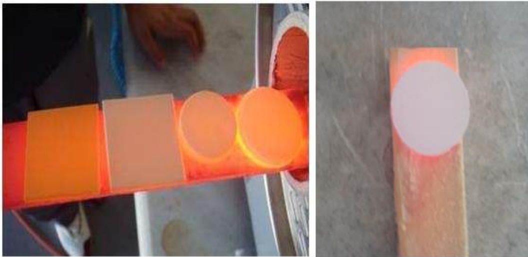
Şekil 5.21. Kaplamalara uygulanan fırın termal şok testi.
