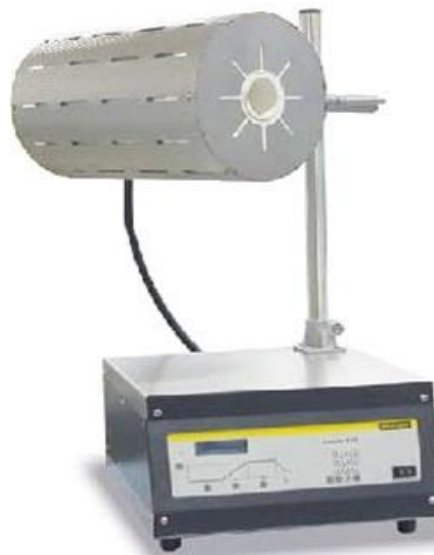
Şekil 5.12. Isıl işlem uygulamasında kullanılan Nabertherm marka tüp fırın.
