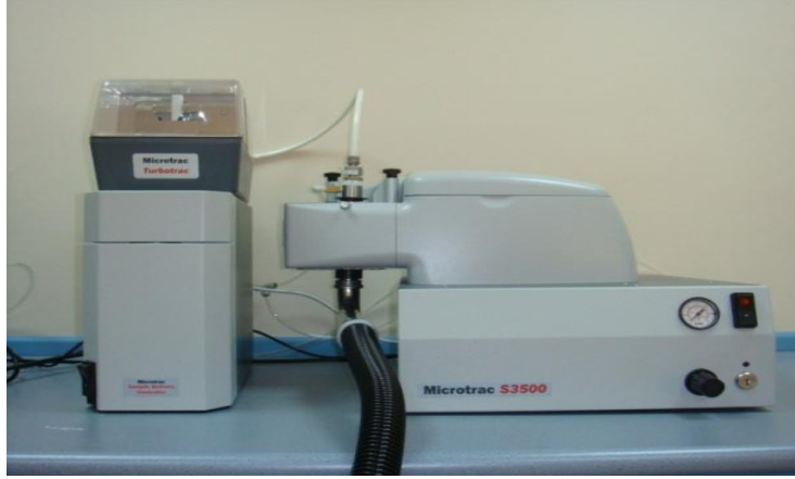
Şekil 5.8. Toz partikül boyut ölçümünde kullanılan Microtrac S3500 marka lazerle partikül boyut ölçme cihazı.
