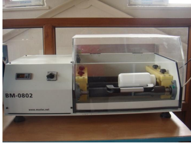
Şekil 5.4. Toz boyut indirgenmesi için kullanılan MSETEC BM-0802 marka öğütücü bilyalı değirmen.
