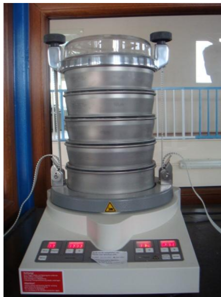
Şekil 5.6. Eleme işleminde kullanılan Fritsch marka titreşimli elek sistemi.
