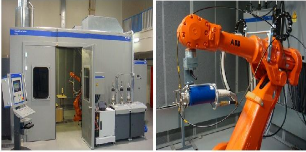
Şekil 5.11. Sulzer Metco plazma sprej sistemi ve robotik sisteme bağlı F4 plazma sprej tabancası.
