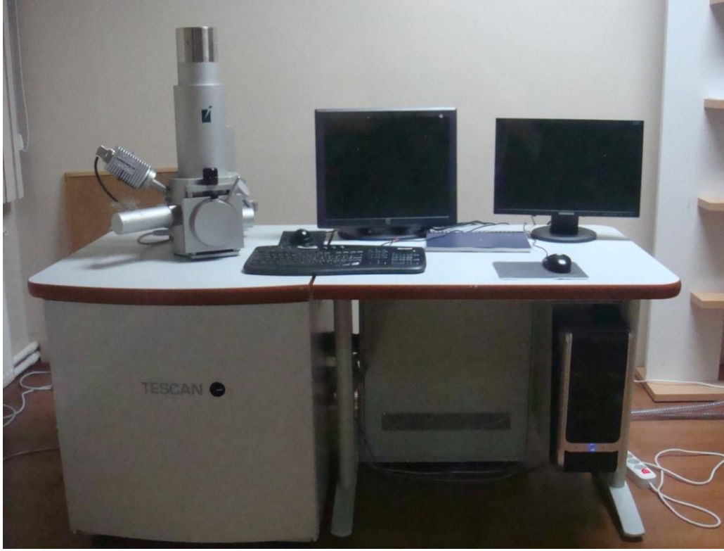
Şekil 5.18. TESCAN marka taramalı elektron mikroskobu (SEM).
