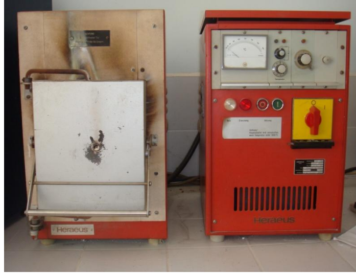
Şekil 5.5. Sinterleme işleminin yapıldığı HERHAUS marka kamara tipi sinterleme fırını.
