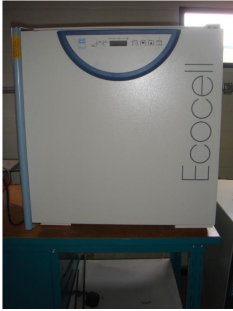
Şekil 5.7. Toz bünyesinde bulunan alkol ve nemi bünyeden uzaklaştırmak için kullanılan Ecocell marka kurutma fırını (etüv).
