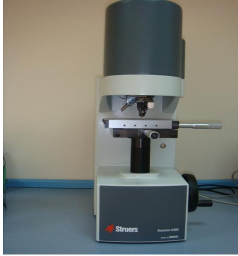
Şekil 5.16. Mikrosertlik ölçümlerinin yapıldığı Struers Duramin A-300 marka mikrosertlik ölçüm cihazı.
