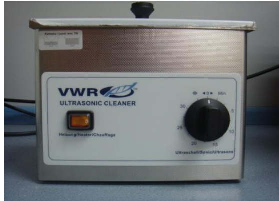
Şekil 5.9. Üretimden gelen ve mevcut bulunan kirliliklerin giderilmesi amacı ile kullanılan VWR marka ultrasonik banyo.
