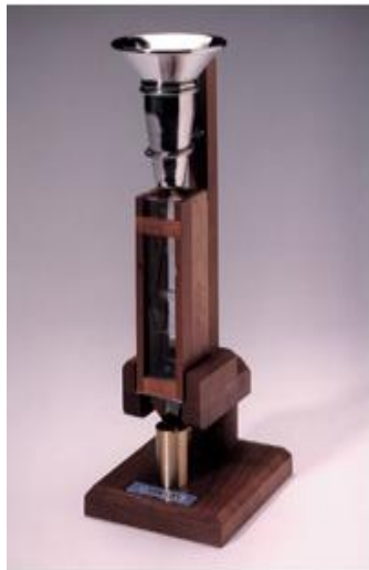
Şekil 2. 32. Scott hacim ölçer cihazı.
