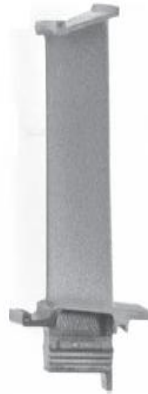
Gaz türbin kanatçıklarında yüksek sıcaklıktaki korozyona karşı MCrAlY kaplamalar (M: Ni, Co)
