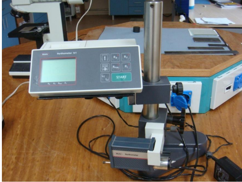
Şekil 5.13. Mahr M1 marka yüzey pürüzlülüğü ölçme cihazı.
