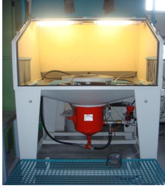
Şekil 5.10. Altlık malzemesinin kumlanmasında kullanılan SAPI marka basınçlı kumlama makinası.
