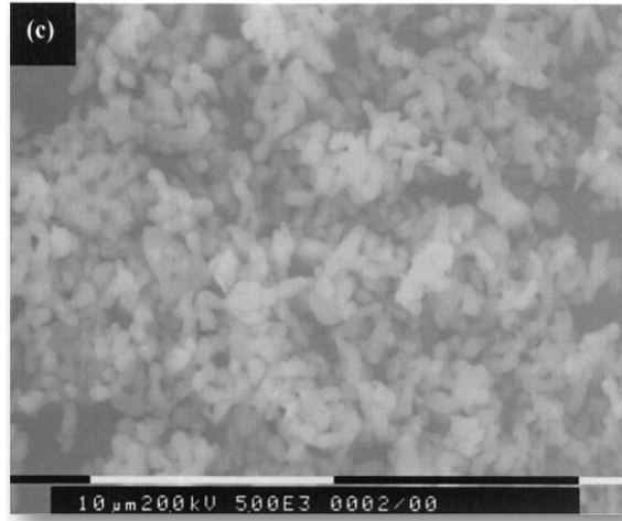
Şekil 2. 18. Sol-jel prosesi ile üretilmiş Y_2SiO_5 tozunun SEM görüntüsü.
