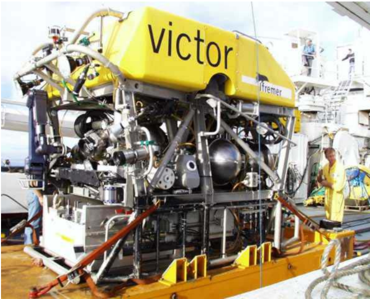
Figura 7 -Sistema de exploración submarina VICTOR 11
