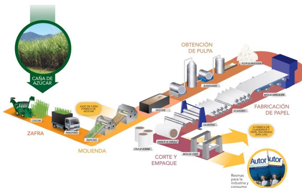
ILUSTRACIÓN N°1 Secuencia del proceso de fabricación de la pasta y el papel
