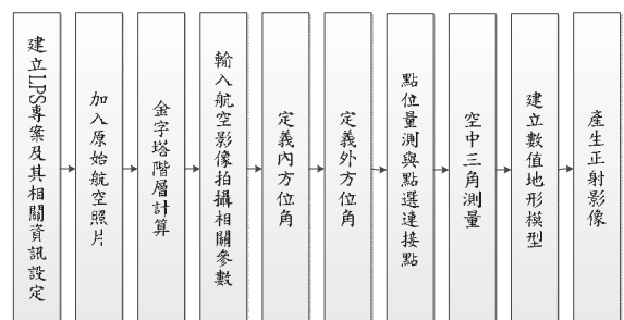
圖 2 數值航空攝影測量製作流程
