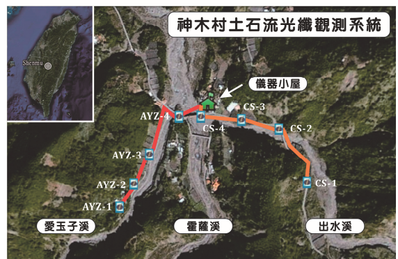
圖 7 神木村土石流光纖感測系統配置圖
