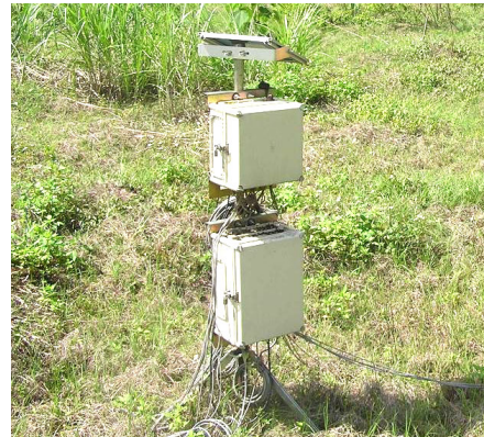
圖 4 . 土壤水分觀測儀器(資料收集記錄器、電源模組及防潮箱) Figure 4 . The datalogger, battery module and water-proof box
