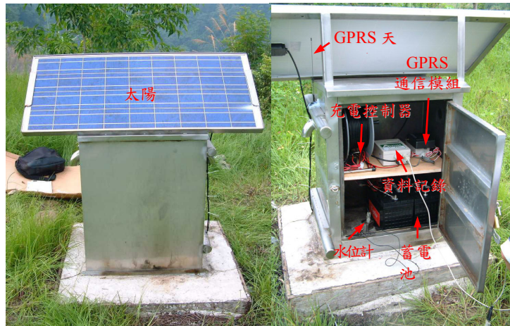
圖 5. 水位自動觀測站之儀器設備 Figure 5. Equipments of automatic water level observation stations.
