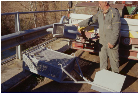
圖 5 Canada 礫石型底床推移載採樣器 Fig.5 Canada sampler for gravel bed load
