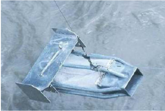
圖 4 Helley-Smith 礫石型底床推移載採樣器 Fig.4 Helley-Smith sampler for gravel bed load
