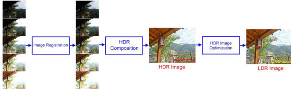
圖 3 高動態範圍影像系統流程圖。
