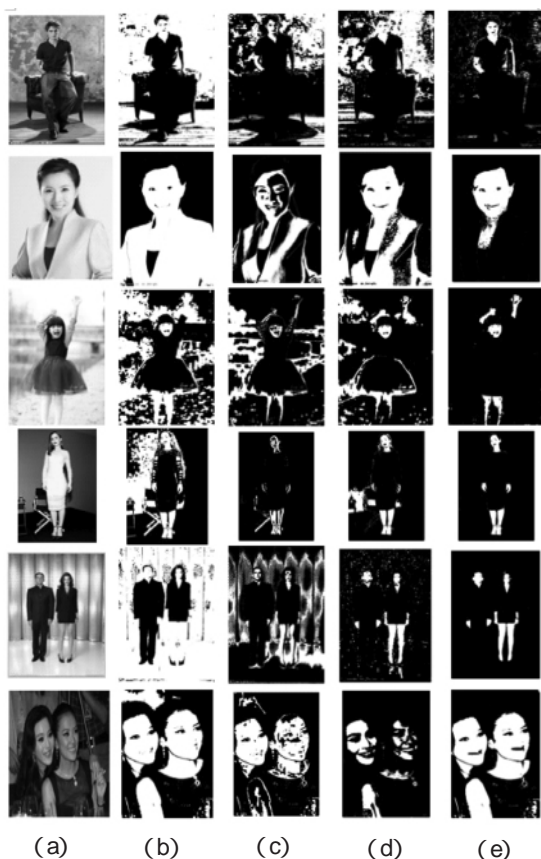
图四 a)原始图像 (b) 二维直方图结果 (c) 高斯模型结果 (d) 动态阈值结果 (e) 融合方法结果
