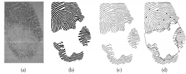
图3 残缺指纹图像的特征提取
