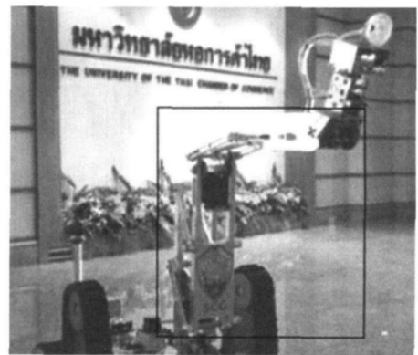
图 1 探测机器人及研究对象机械臂(方框中)
